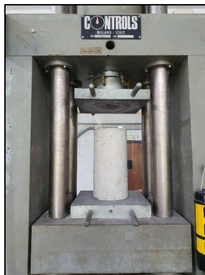
รูปที่ 7 การทดสอบกำลังอัดของก้อนคอนกรีต
